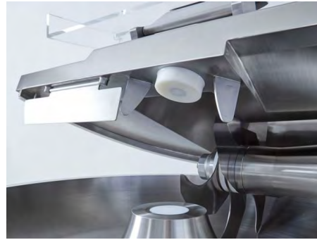
Superficies pulidas lisas, sin rincones ni tornillos, con radios C € para facilitar la limpieza.
