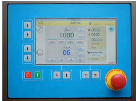
Pantalla digital de control y programación de todas las funcionalidades de la cutter.
