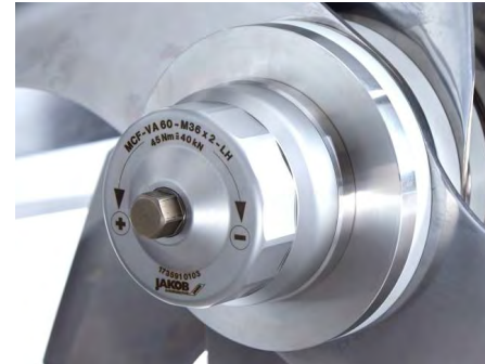
El cierre rápido Talsa Quicklock reduce el tiempo de desmontar y montar las cuchillas en el cabezal.
